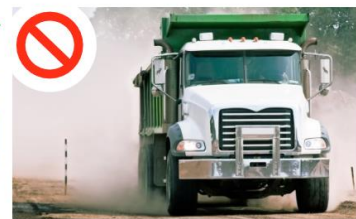
Absence de piste de chantier temporaire (dégagement de poussières important).
